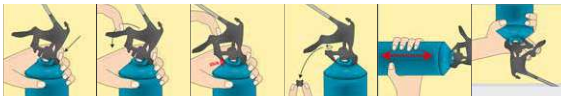
Монтование адаптера на puszcze pianki ręcznej Схема закрепления адаптера на баллон
