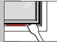
**Kunststoff Klötzchen 1017** zeichnen sich durch die hohe Tragfähigkeit bedingt durch verstärktes Stegsystem und die geprüfte Verträglichkeit mit vielen Randverbunddichtstoffen aus. Der eingesetzte hochwertige Kunststoff ist alterungs- und temperaturbeständig – kein Regenerat – zu 100% aus Neumaterial. **Entspricht der DIN 18545**
