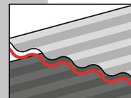
**Ramoflex R 1110** ist ein hochwertiges, stark klebendes Dichtungsband, welches sich besonders für Metallüberlappungsverklebungen im Glas-, Holz-, Kfz- und Wohnwagenbau eignet.
