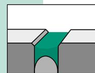
**Bodenfuge 316** ist ein schnellhärtender, dauerelastischer Hybriddichtstoff mit sehr hoher mechanischer Festigkeit und guter Haftung. Der Dichtstoff wurde für Fugen mit hohen Anforderungen im Bezug auf mechanische Belastung, wie z. B. Bodenfugen, entwickelt. **EC1-Plus · Geprüft nach DIN EN ISO 11600 Typ F Klasse 25 HM · Geprüft nach den europäischen Emissionsanforderungen IAC EU**
