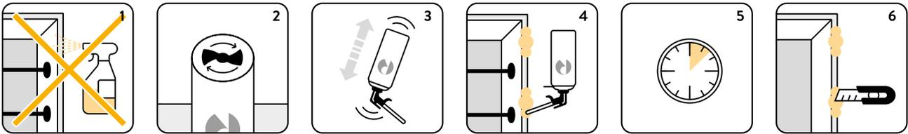
**1** Der Untergrund muss sauber, fest, trocken, staub- und fettfrei sein. Die Elemente sind nach Vorschrift auszurichten, zu verkeilen und zu montieren. Angrenzende Flächen abdecken (z. B. mit Ramsauer Abdeckband). Untergrund NICHT anfeuchten! Ramsauer 2-K-FIX härtet unabhängig von Feuchtigkeit aus.
