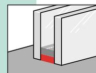
**Randverbund 380** eignet sich wegen seiner ausgezeichneten Haftung auf Glas, Aluminium und verzinktem Stahl hervorragend zur Verklebung des Isolierglasverbundes. **Extreme UV-Beständigkeit • VSG-verträglich**
