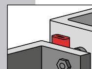
**Ramoflex R mit Seele 1120** ist ein hochwertiges, stark klebendes Dichtungsband mit eingelegtem Kunststoffkern, welches sich besonders für Metallüberlappungsverklebungen im Glas-, Holz-, Kfz- und Wohnwagenbau eignet.
