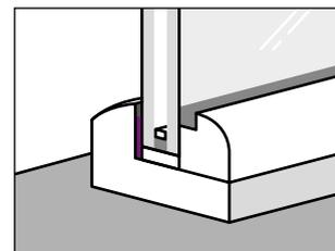
Überschlagsverklebung der Isolierglaseinheit auf Position 1
