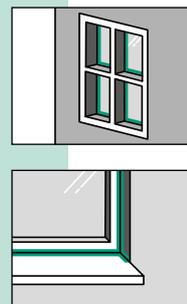
**Multiflex 131** ist ein geruchsneutraler Silikondichtstoff zur Versiegelung im Glas- und Fensterbau sowie für die Abdichtung von Anschlussfugen. Gute Haftung ohne Primer, anstrichverträglich, abriebfest. **Geprüft auf Verwendbarkeit bei Kontakt mit VSG-Gläsern im Kantenbereich** • Geprüft nach **DIN 18545 Teil 2 Gruppe E** • Entspricht **DIN 18540 Teil 1** • Geprüft nach **DIN EN ISO 11600 Klasse G 25 LM**
