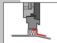
**Anschlussband Innen 1093** ist eine flexible, reiß- und weiterreißfeste sowie stark dampfbremsende, überputzbare Folie für die bauphysikalisch warme, d. h. innenseitige Abdichtung von Fenster- und Türanschlussfugen. Leichte Montage am Fenster- und Türanschlüssen durch integrierten stark haftenden Selbstklebestreifen.
