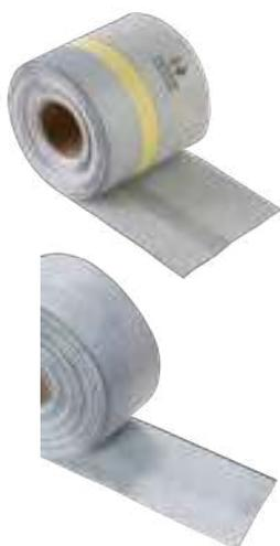
Elastisches Dichtband auf NBR-Kautschuk-Basis mit beidseitiger Vliesbeschichtung und einseitig starkklebendem Butylkautschukklebestreifen. Zur universellen Abdichtung von Dusch- und Badewannen aus emailliertem Stahl bzw. Kunststoff.
